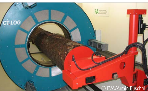
Das österreichische Versuchsmaterial wird auf dem MicROTEC-Forschungstomographen der FVA Baden-Württemberg gescannt
